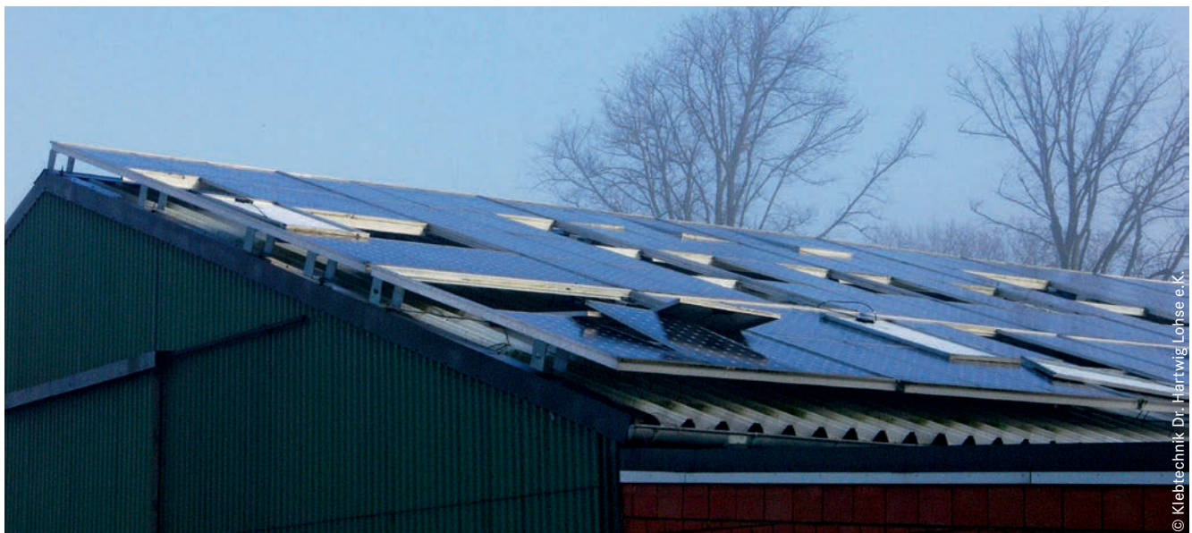
Bild 1: Reihenweises Versagen der Klebverbindungen nach hoher Windbelastung zwischen Solar-Modulen und Aluminium-Unterkonstruktion infolge gravierender Klebfehler
