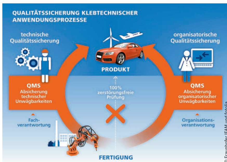
Bild 4: ISO 9001 - technische und organisatorische Qualitätssicherung als „Umweg“ zur Sicherstellung der Produktqualität bei speziellen Prozessen, weil Qualität nicht zu 100 % zerstörungsfrei prüfbar ist
