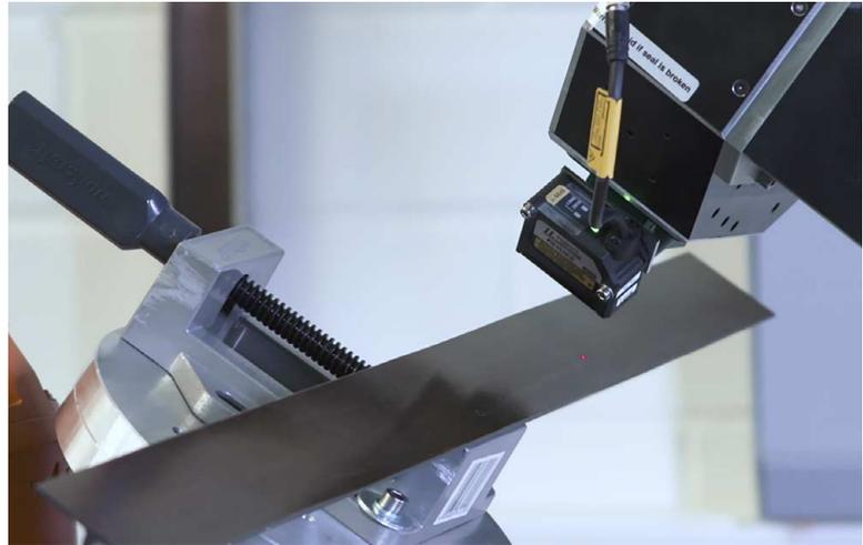
**Die Firma LTB Lasertechnik Berlin hat zusammen mit dem Fraunhofer IFAM im Rahmen des Projektes Alaska einen LIBS-Messkopf konstruiert, der an einem Kuka-Roboter zum Einsatz kommt.**
