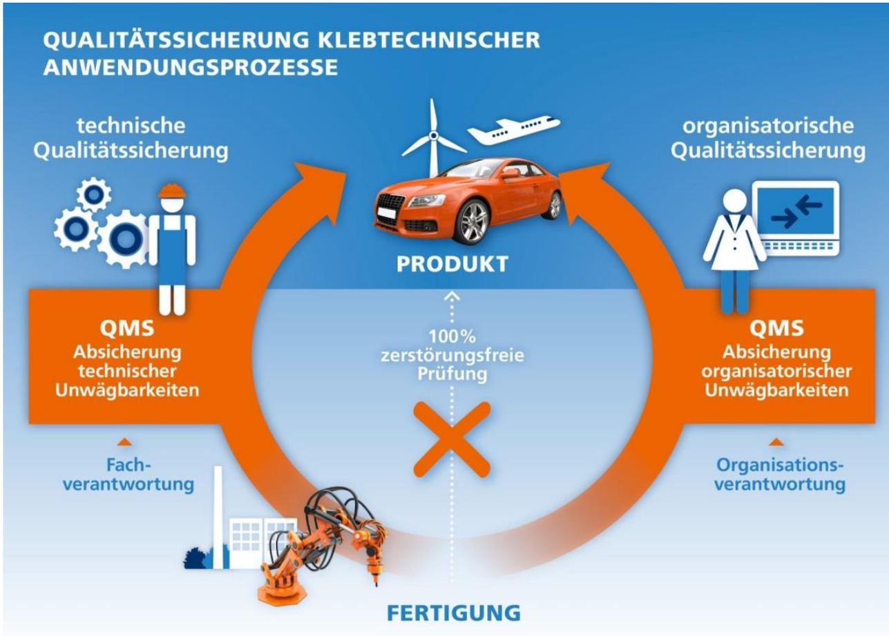
„Spezielle Prozesse“ wie Schweißen und Kleben sind nicht zu 100% zerstörungsfrei prüfbar
